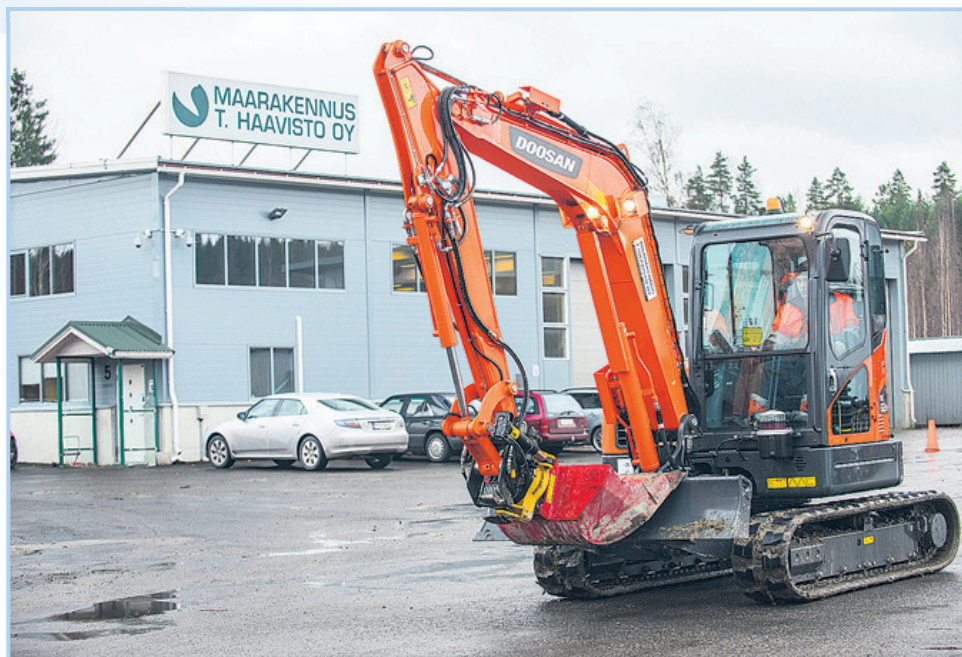
Doosan DX62 R tyvitaitokoneet engconin rototilillä ja Real Machineryn kauhoilla varustettuna on hankittu sekä pien-, rivi-, että kerrostalojen ympäröiväihin. 6,3 -tonninen, 36,2 kW:n tehoinen kone ulottuu vajaan neljän metrin syvyyteen. Riittää hienosti noihin töihin. Tässä uusi kone on tullut ensimmäiseen pikahuoltoon omalle korjaamolle. Yrityksen korjaamo työllistää kolme omaa mekaanikkoa, joiden käsissä syntyy myöskin teräsrakenteita ja muuta rakennusprojekteihin tarvittavaa materiaalia.
